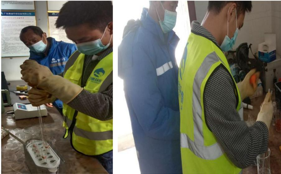
图 6 项目现场检测人员进行水样检测
